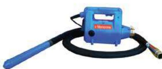
Vibrador con sistema de acoplamiento del chicote es simple y muy eficiente, pues aún con la salpicadura del concreto es facil de acoplar/desacoplar y permite el giro libre del chicote evitando sobre esfuerzos y rupturas del alma de acero.
