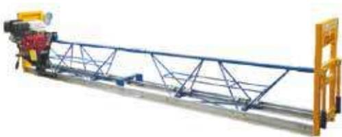
Para el vibrado de lozas entre 13 hasta 28 cm de espesor, es una máquina robusta para el trabajo pesado. Cuenta con un 2 malacates manuales de arrastre con cable integrado en los extremos de la regla para realizar el movimiento de avance.
