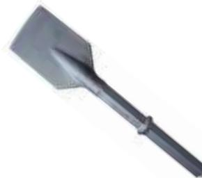
Punta tipo CORTA ASFALTO, ideal para la demolición de suelos con espesores menores a 5 cm. brindándonos gran velocidad de avance para fracturar el concreto/ asfalto en bloques más grandes.
