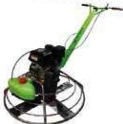
El diámetro es de 36", lo que le permite realizar el trabajo tanto de allanado y pulido con gran avance y en áreas de trabajo de medianas a grandes. La única que incluye tanque de agua para el riego que se controla desde el mango de la maquina.
