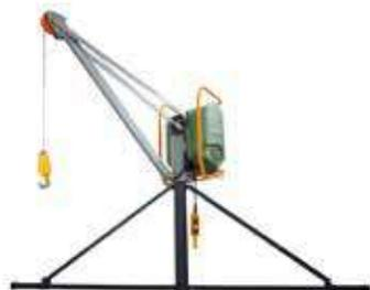
El polipasto Umacon tipo pluma de 500Kg Para la elevación de materiales, es un equipo muy seguro, ya que cuenta con un sistema autofrenante que bloquea el aparato tan pronto se produce un corte de corriente y así mismo puede arrancar a plena carga desde cualquier punto muerto del recorrido.
