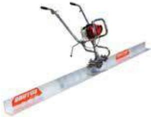
La regla de concreto manual modelo "Brutus 3L", herramienta ideal para el vibrado de hormigón en firmes y calles.
